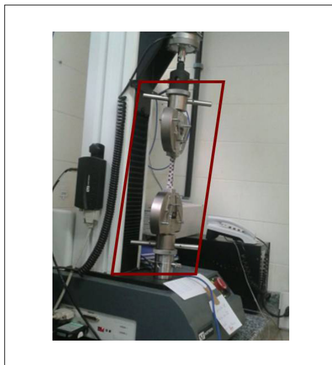
Figura 1 - Corpo de prova de pele de tilápia montado em Single Column Universal Testing Systems for Capacity Testing up to 5 kN Instron® 3345, no módulo de tração.
